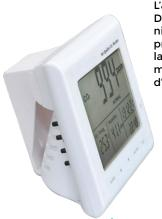
L'appareil de mesure du CO<sub>2</sub>, modèle DC-200, vous informe en temps réel sur le niveau exact de dioxyde de carbone (CO<sub>2</sub>) présent dans la pièce. Il permet d'afficher la concentration du CO<sub>2</sub> en ppm (partie par million) sur son écran LCD avec 3 niveaux d'indication :
